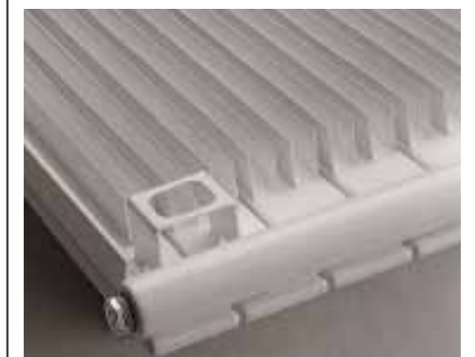
VN1L1 met aan de achterzijde open U-profielen ter verhoging van de warmteafgifte
